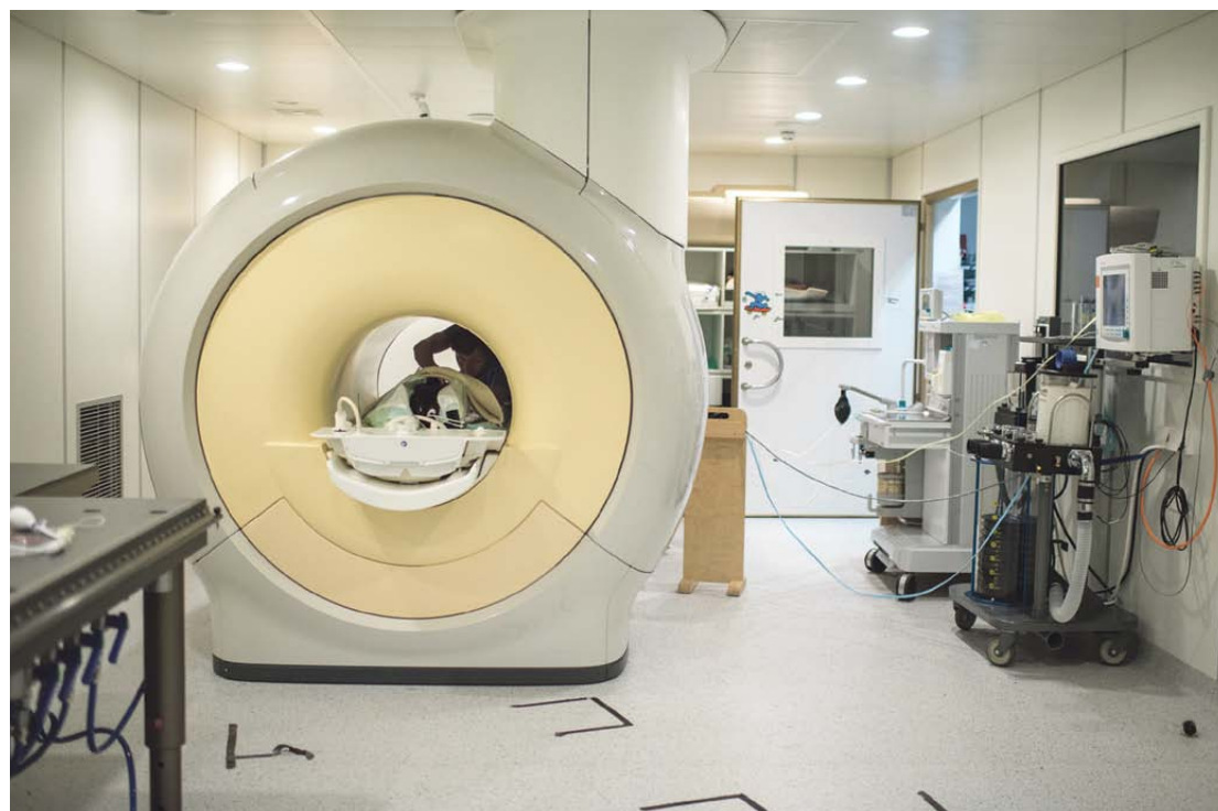
Der 3 Tesla Magnetresonanztomograph des universitären Tierspitals
